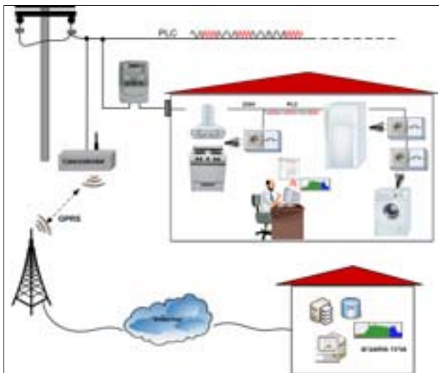
איור 5: רשת HAN (ביתית) מכשירי החשמל מחוברים ל-"מתג-תגובת-ביקוש", מבוסס תקשורת PLC בתוך הבית
