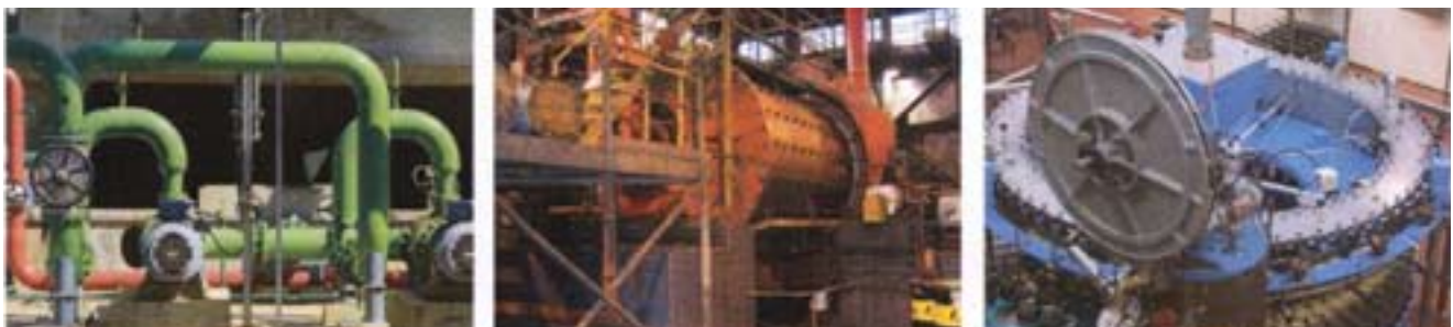
צילום 2. אחזקה חזויה מתאימה באופן מושלם ליישום במקרים של עומסים בלתי סדירים כגון במטחנות כדורים, במגרסות וכמו כן בסרטים נעים ומשאבות.
